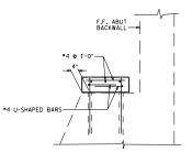
\* <u>ALTERNATE DETAIL</u> TO BE USED FOR CASES WHERE HEIGHT EXCEEDS 1'-0" OR INSUFFICIENT EDGE DISTANCE (PRECAST OPTION SHOWN)
